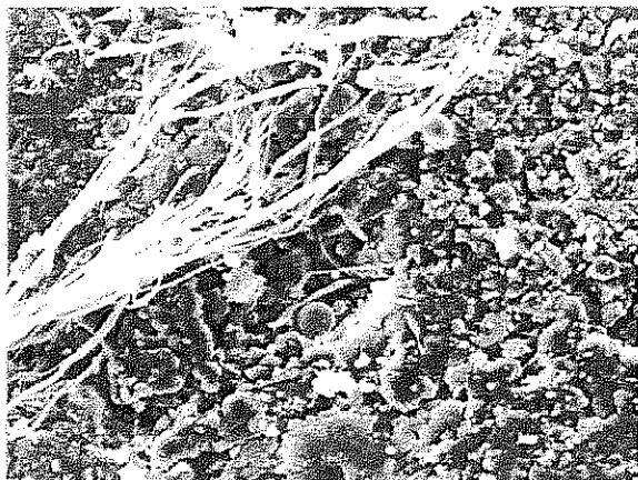
Rys. 4. Korozja płyt a-c – widoczna wiązka całkowicie odsoniętych włókien (pow. 400x) (wg J.Dyczek)
